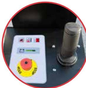
Крепкий джойстик с максимально подобранными пропорциями позволяет осуществлять управление работой аппарата, в частности при выполнении им подъема и опускания грузов. Эргономический дизайн с задним рычагом, активирующим выполнение заданных функций, позволяет осуществлять захват грузов с максимальной точностью и надежностью даже при использовании оператором рукавиц.
