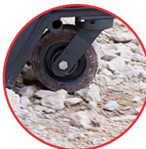
Широкие приводные и управляющие колеса позволяют уменьшить нагрузку машины на поверхность рабочей зоны и обеспечивают лучшую устойчивость машины на ней.
